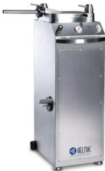
Le finiture e la qualità dei materiali utilizzati conferiscono alla I40H una longevità ed un'affidabilità eccezionali. La macchina è dotata di centralina idraulica che gestisce il movimento del pistone. La velocità di salita è regolabile per avere la possibilità di insaccare qualsiasi tipo di prodotto. Dotata di manometro per verificare la pressione.
