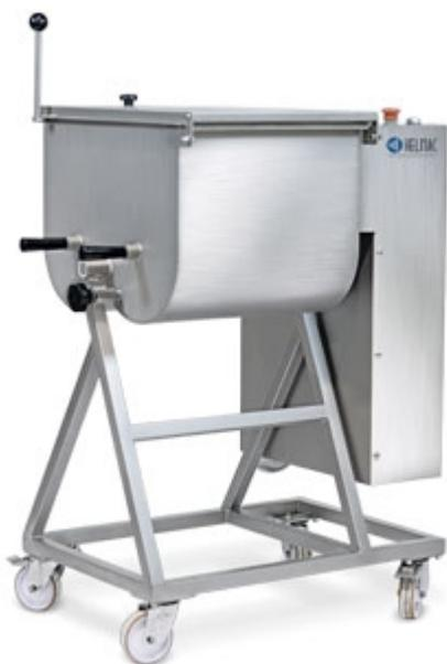
Impastatrice bipala in acciaio inox dotata di vasca ribaltabile per un miglior scarico dell'impasto. Il coperchio è munito di aperture per l'immissione degli aromi durante la lavorazione. La vasca è montata su un telaio dotato di ruote girevoli, di cui due con freno. Il motoriduttore a due uscite a vite senza fine garantisce una perfetta sincronia delle pale. Inversione di marcia a impulso.
