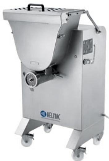
Tritacarne da pavimento autoportante con ruote inox dotate di freno. Strumento completo di sensore di sicurezza su coperchio con sistema di auto-apertura, interamente costruito in acciaio inox. Gruppo di macinazione studiato per grandi prestazioni. Facile da pulire grazie al rapido sistema di smontaggio di bocca e pala, senza l'uso di attrezzi.
